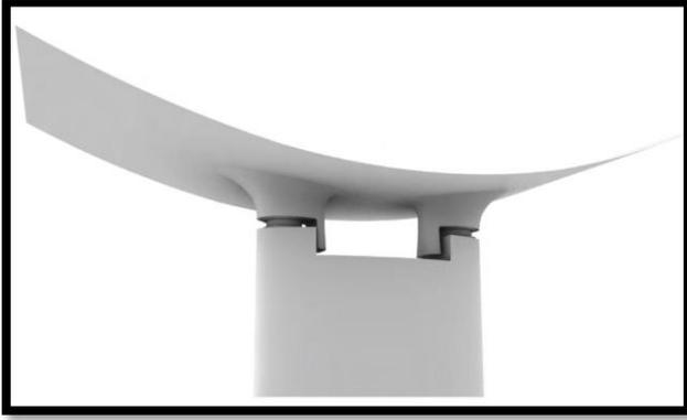
Il dettaglio del punto di appoggio dell'impalcato sulle pile che sorreggono il viadotto. Il sistema consente al ponte di “respirare” senza impattare sulla sua stabilità e resistenza.
